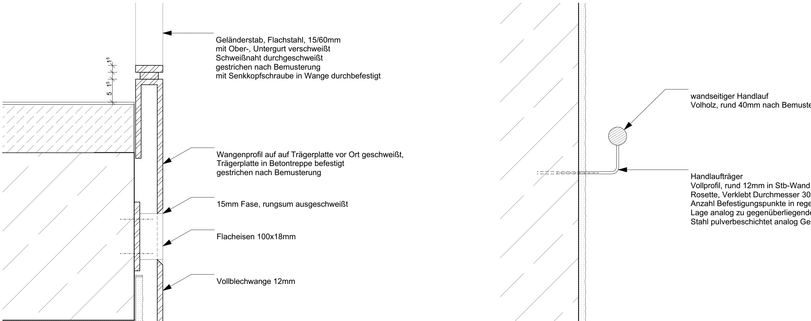
Detail Geländeranschluss Treppenauf (1:5)
